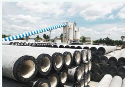
조강 포틀랜드 시멘트는 초기강도 발현에 효과적인 제품으로 제조 과정에서 비표면적이 높으며, 통상적으로 재령 7일만에 재령 28일 강도를 나타내는 제품입니다. 주로 증기양생 제품인 PC 및 PHC파일 제품에 사용되며 공사기간 단축, 긴급 공사에 사용되는 제품입니다.
